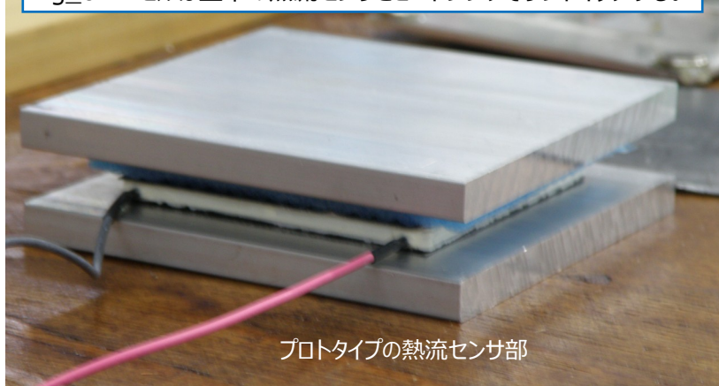
Fig_01 : セルは上下の熱流センサとヒートシンクでサンドイッチする。
